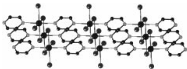
Abbildung 36. Die Schichtstruktur von [\text{Cd}(\text{pz})\text{Cl}_2] .
